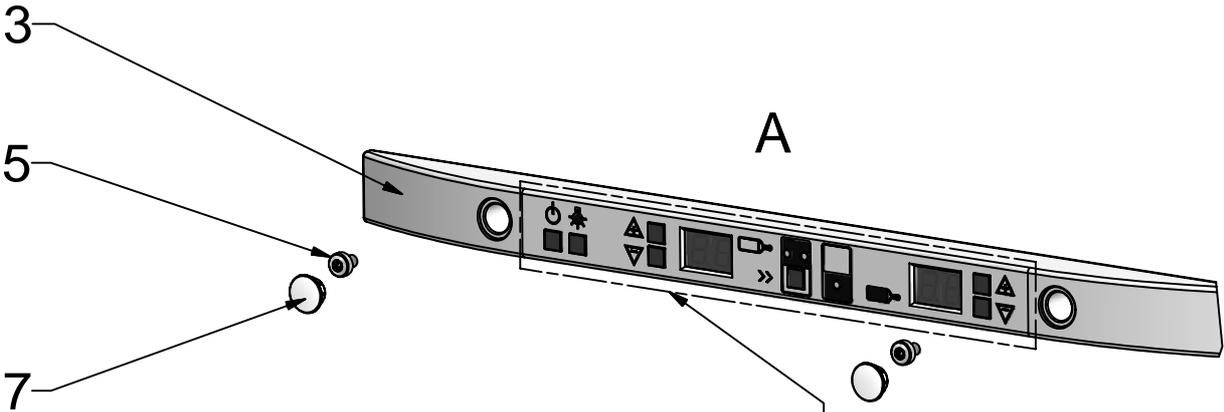
Vor Demontage der Printplatte, Frontpartie mit Klebeband abkleben.
