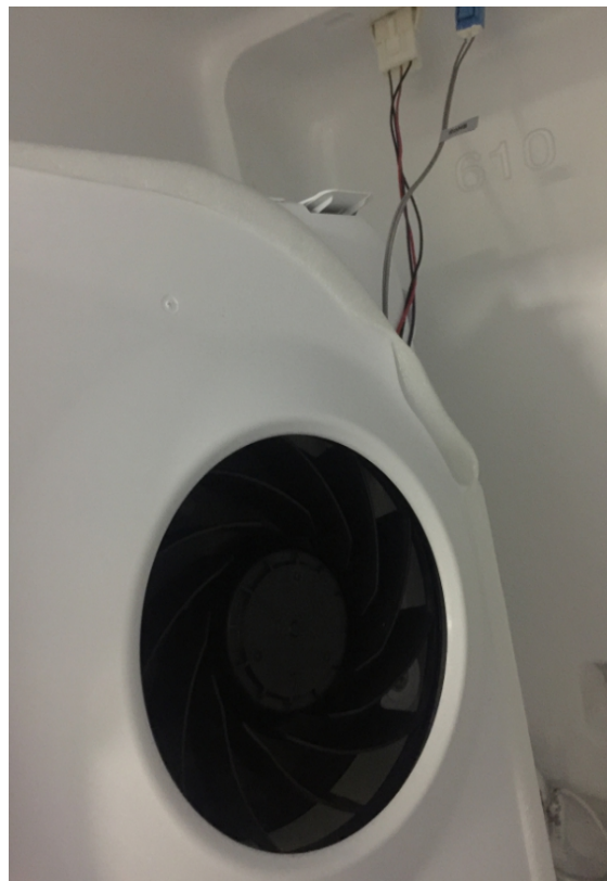
Freezer fan motor
