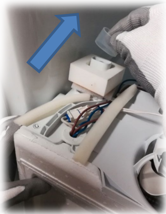
5. Remove the cold module
