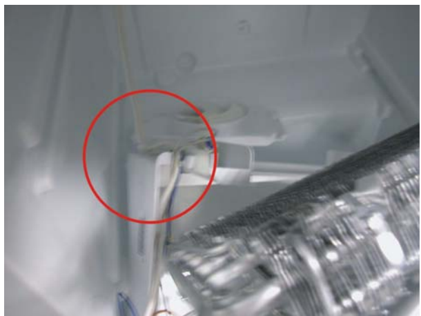
t) Remove the wiring fixing tie.
